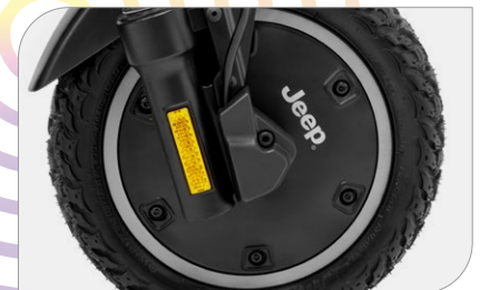
Moteur brushless, puissance maximale de 700 W
