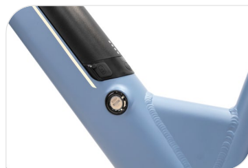
Batterie semi-intégrée 36 V, 10.4 Ah, 375 Wh, BMS
