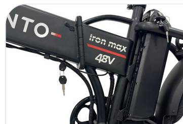
Doppia batteria Greenway 48 V, 15 Ah + 10.4 Ah, 1220 Wh, smart BMS, celle LG
