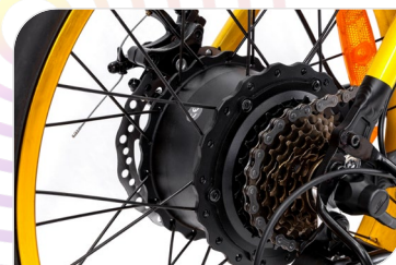
Motore Sutto Bafang, 250 W, 55 Nm
