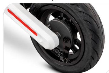
Freno a tamburo anteriore e a disco posteriore, due leve freno
