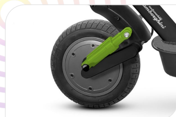
Moteur Brushless, 15 Nm, KERS, Puissance maximale 900 W
