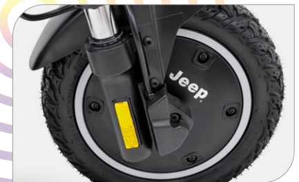
Moteur brushless, puissance maximale de 670 W
