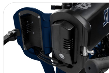
Batteria Greenway 48 V, 10.4 Ah, 500 Wh, smart BMS, celle LG
