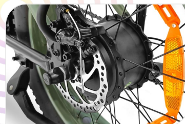
Motore Sutto Bafang, 250 W, 36 V, 70 Nm
