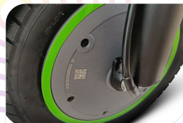
Moteur Brushless 15 Nm, KERS, Puissance maximale 900 W
