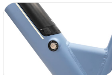
Batteria semi-integrata 36 V, 10.4 Ah, 375 Wh, BMS
