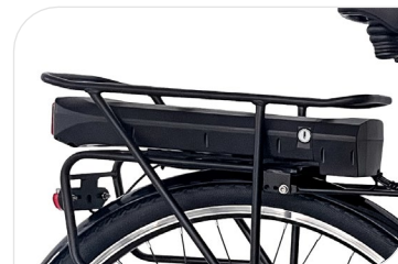
Batteria Greenway 36 V, 7.8 Ah, 281 Wh, smart BMS
