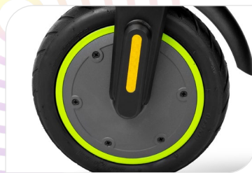
Moteur Brushless 14,5 Nm, KERS, Puissance maximale 500W
