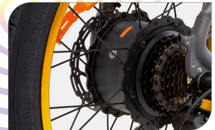
Moteur arrière 48 V, 250 W, 55 Nm
