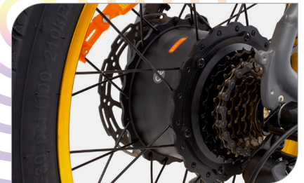
Motore posteriore 48 V, 250 W, 55Nm
