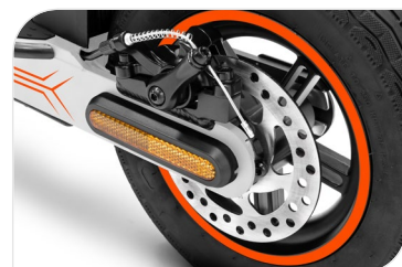
Freno elettrico anteriore e a disco posteriore, con doppia leva freno
