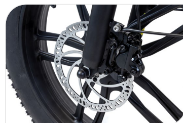
Freni a disco idraulici con cut off
