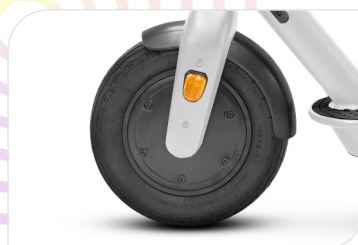
Moteur Brushless, 15 Nm, KERS, Puissance maximale 700 W
